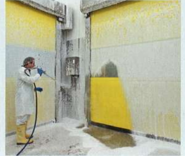
V 2515 Food L Kolay temizlik: Mil, yan parçalar ve şalter kutusu komple paslanmaz çelik.
